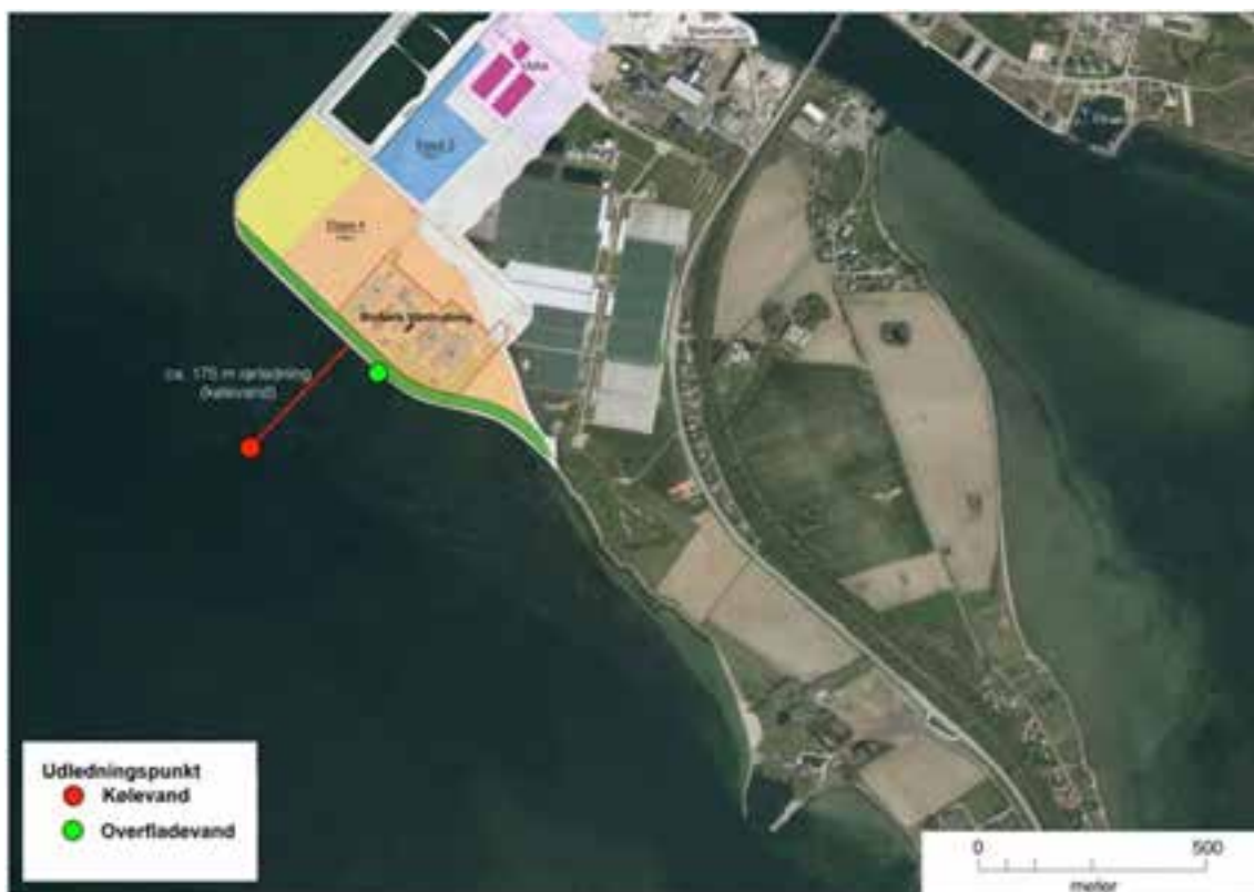
Figur 4-46: Ortofoto fra sommeren 2016 af kysten omkring Masnedø med angivelse af Masnedø Vestflak, Masnedø Kalv og bredden af mosaikbunden ud for det projekterede anlæg, hvor udledningspunktet pt. er lagt på ca. 5 meter vand. Udledningspunktet for kølevand ligger ca. 175 meter fra stensætningen.
