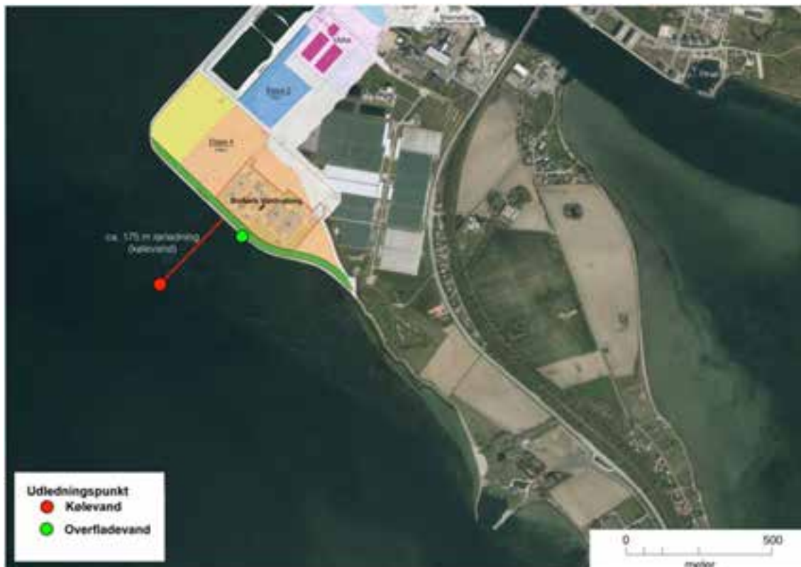
Figur 4-27: Rørføring og udlædningspunkter for overfladevand, spildevand og kølevand, henholdsvis ca. 0, 160 og 175 m fra stensætningskant.
