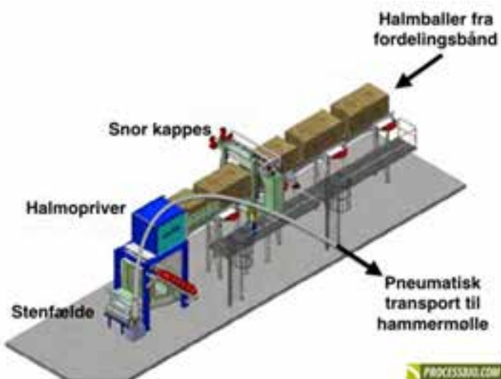
Figur 3-7: Findelingslinje med snorkapper, halmopriver, stenfælde og transport til hammermølle
