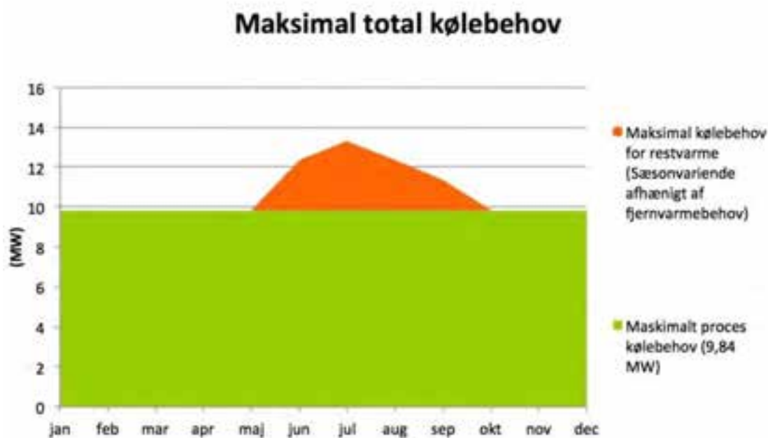
Figur 4-36: Maksimalt kølebehov for Bioraffinaderiet kan aflæses til 13,5 MW i juli måned.
