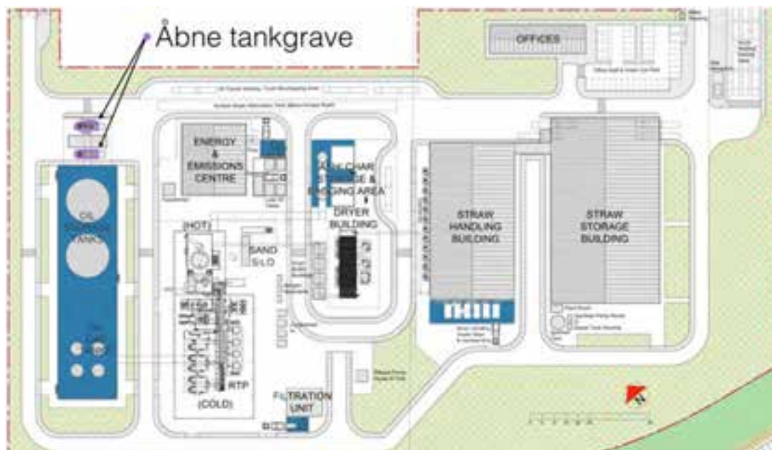
Figur 4-28: Situationsplan, hvor oplagspladser/tankgårde med mekaniske spjæld ved udløbet indikativ er markeret med blå. Desuden er de to åbne tankgrave under bioolie-påfyldningsområderne markeret med lilla.
