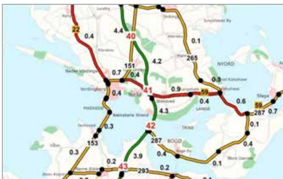
Figur 4-18: Vejdirektoratets årsdøgntrafiktal (decimaltallene langs vejene) i tusinder for køretøjer længere end 5,8 meter på rutenummererede veje. (Transportministeriet og Vejdirektoratet 2013)
